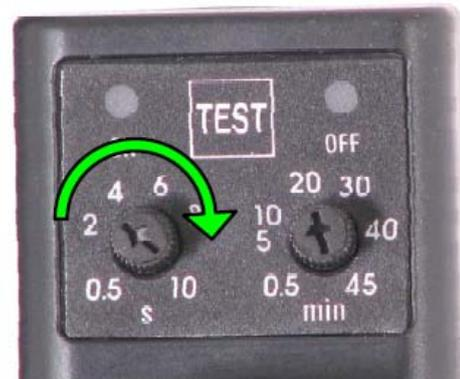
**15.** Ajustez le bouton OFF pour installer votre système par exemple pour 20 min.
